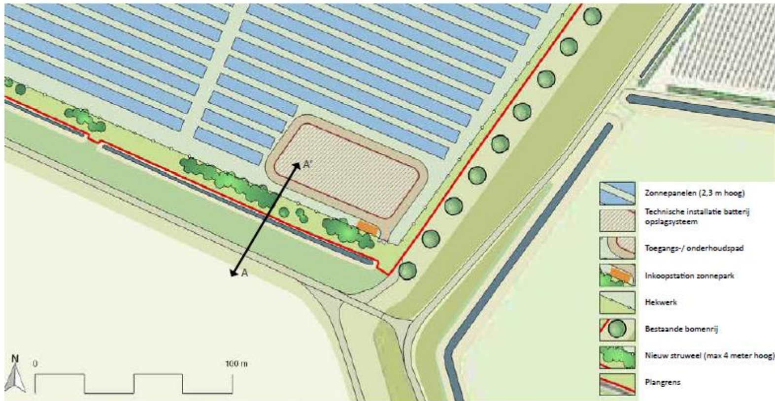
Afbeelding 2. Energieopslagsysteem zonnepark de Eendracht met dwarsprofiel lijn.
